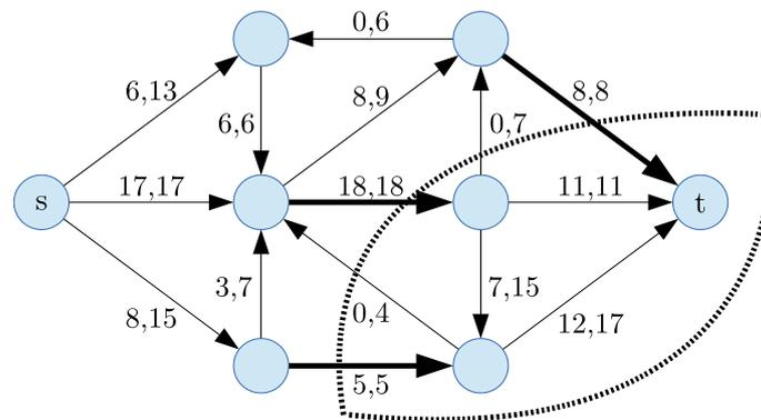
Die folgende Abbildung zeigt den Restgraphen für den oben dargestellten Fluss. An den Kanten ist die jeweilige Restkapazität ( $c_e - x_e$  oder  $x_e$ ) notiert.
